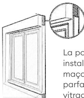
La pose en applique consiste à installer la fenêtre en appui sur la maçonnerie. Ce principe assure une parfaite étanchéité et un clair de vitrage maximal.
