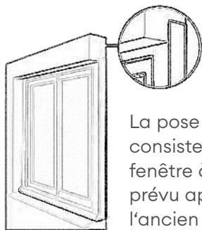
La pose en feuillure, consiste à installer la fenêtre à l'emplacement prévu après avoir retiré l'ancien châssis.
