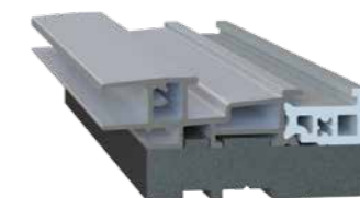
REHAUSSE DE SEUIL 15 MM Compense la hauteur du sol fini avant pose du carrelage ou coulage de la chape. Empilable.
